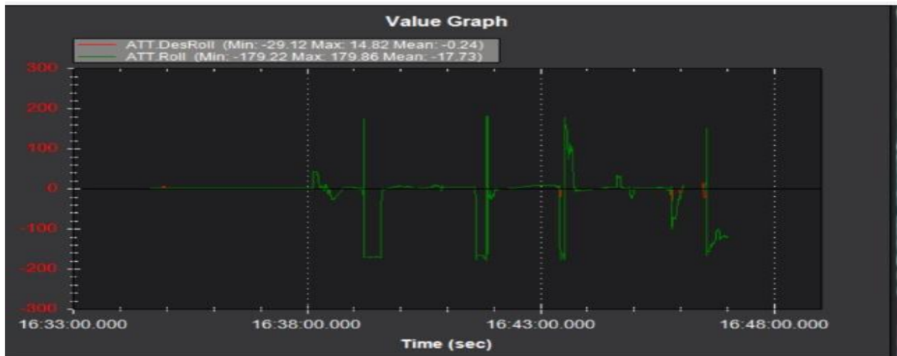
Figure 61 Roll Desired VS Roll actual
